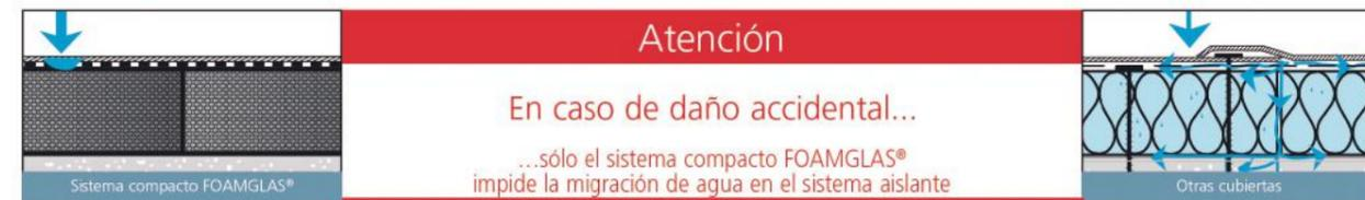
La utilización del FOAMGLAS® permite también una continuidad funcional de las cubiertas con utilizaciones diferentes: ajardinadas, pódium, solados, aparcamiento, auto protegidas, ...lo que elimina puentes térmicos y puntos de encuentro mejorando la performance térmica de la cubierta con un espesor mínimo (EN ISO 6946) y disminuyendo el riesgo de infiltraciones.
